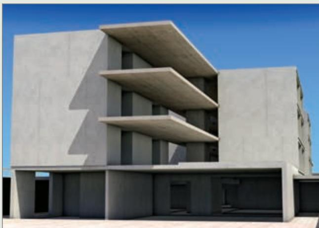
**Tragwerksmodell:** Den Bauingenieur interessieren primär die tragenden Bauteile. Details wie Fenster und Türen kann er im 3D-Modell auf Knopfdruck ausblenden.
